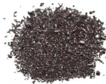
Рис. 15. Внешний вид лигатурной стружки слитка сплава Ц-Н57
