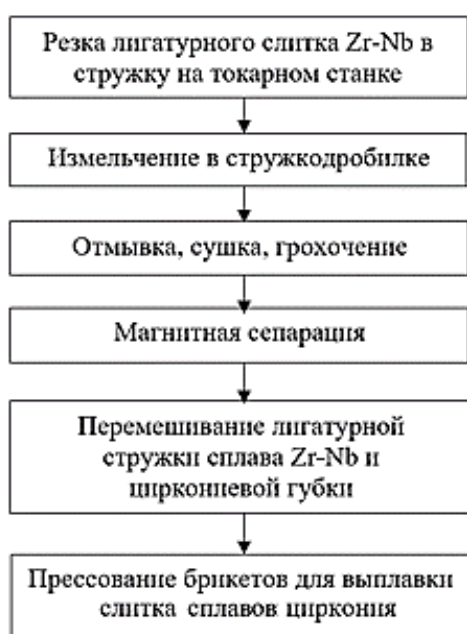
Рис. 14. Схема получения лигатурной стружки слитка Ц-Н57
