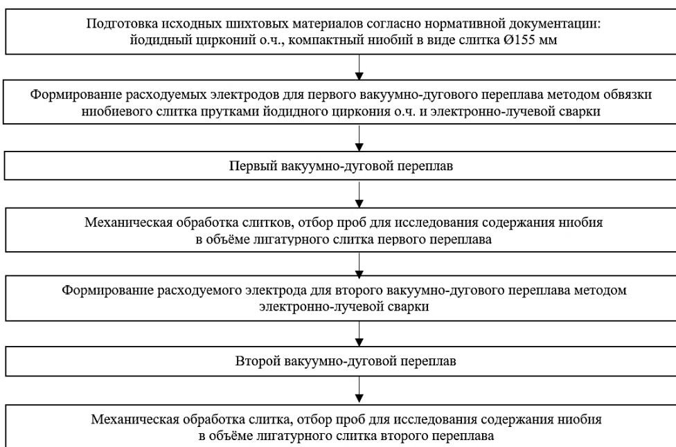
Рис. 2. Схема выплавки лигатурного слитка сплава Ц-Н57
