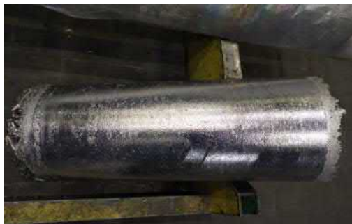
Рис. 4. Внешний вид лигатурного слитка сплава Ц-Н57 второго вакуумно-дугового переплава
