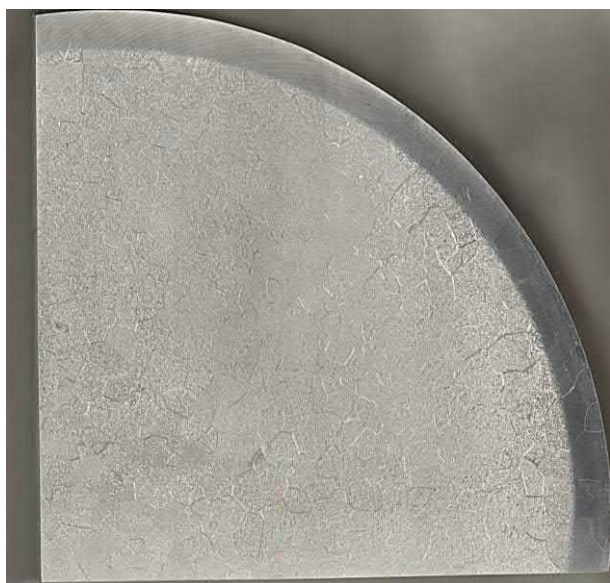
Рис. 9. Макроструктура \frac{1}{4} части темплета лигатурного слитка сплава Ц-Н57, поперечное сечение
